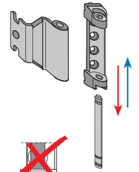
**Aushängen:** Scherenlagerstift bei geschlossenem Flügel nach unten ziehen.
