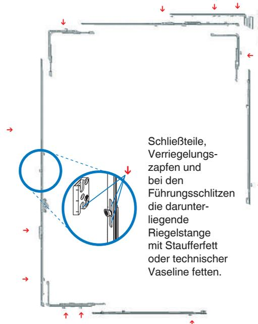
Schließteile, Verriegelungszapfen und bei den Führungsschlitzen die darunterliegende Riegelstange mit Staufferfett oder technischer Vaseline fetten.
