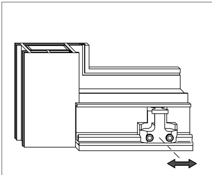
**9** Seitliche Falzlufte unten, zwischen Rahmen und Schiebeflügel, muss links und rechts gleich sein.
